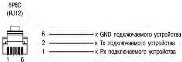
Рисунок Г.3 – Схема кабеля для подключения к порту RS-232 и Debug RS-232
